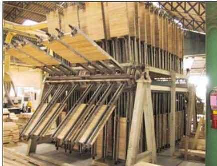
Les panneaux sortent du moulin et sont mis sur un bloc pour passer dans le séchoir **pour la troisième fois**. Plus vite la colle sèche, meilleure est la tenue de la colle et moins de risque de décoloration ou tâches dans le bois. Sorti du séchoir, le panneau est centré et scié parfaitement sur mesure. La ponceuse finit le panneau sur l'épaisseur. Standard : Grain 180 sur les 2 faces.
