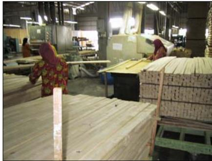
Ensuite, les bandeaux sont collés et placés dans un moulin de collage. On remplit suivant la largeur désirée du panneau.
