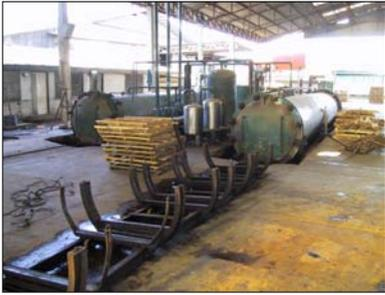
Tout de suite après le sciage, le bois frais doit être traité afin de prévenir la détérioration et les attaques par les vers ou insectes. En principe le traitement doit se faire dans la semaine après l'abattage. La seule bonne méthode est le traitement sous vide en autoclaves : des produits de préservation sont introduits dans la masse de bois par pression hydraulique, ce qui nous garantit une protection permanente du bois.
