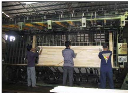
Une presse hydraulique (jusqu'à 120 tonnes) presse les bandeaux ensemble et le moulin tourne pour le panneau suivant.
